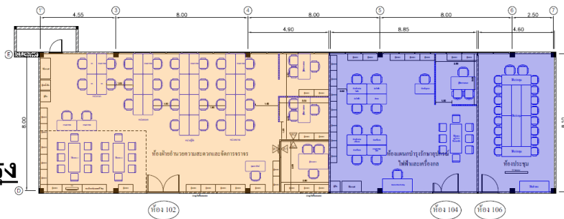
แบบแปลนผังโต๊ะทำงานห้อง 102, 104, 106 (ระยะที่ 2) SCALE 1:50
